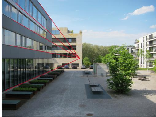
Auf dem obenstehenden Bild ist erkennbar, dass parallele Kanten in der zentralperspektivischen Ansicht nicht parallel sind. Bei Verlängerung der Kanten kommt es zu einem Phänomen: die Geraden treffen sich in einem Punkt, dem Fluchtpunkt  $F$ .
