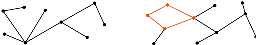
Abbildung 6.14: Der linke Graph ist ein Beispiel für einen Baum. Der rechte Graph ist kein Baum, weil er den farbige markierten Kreis enthält.
